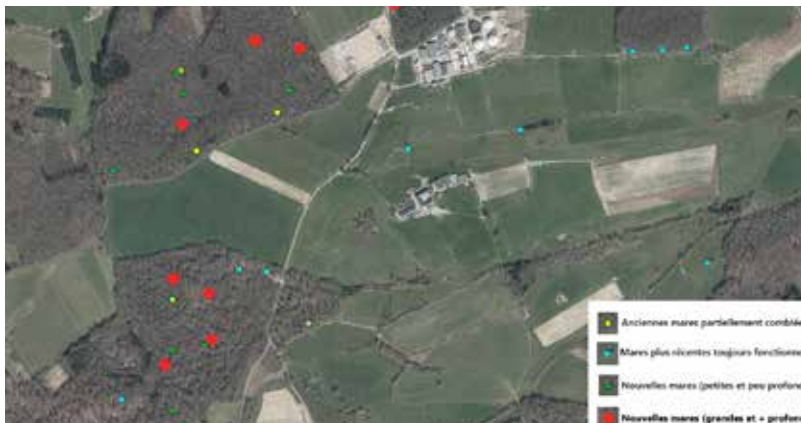
Réseau de mares entre Tontelange et Grendel. Vingt nouvelles mares de tailles et de formes très variées ont été creusées, de configurations réfléchies pour favoriser la vie au maximum (pente douce, grandes longueurs/circonvolutions de berges, exposition au soleil, micro-habitats, etc).
